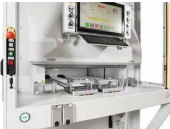
cleanCELL 2220 pour l'adhésif Prétraitement des boîtes de vitesses et des boîtiers de commande
